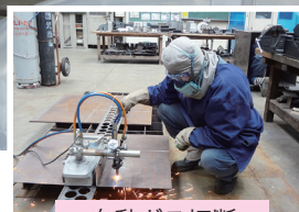
自動ガス切断
